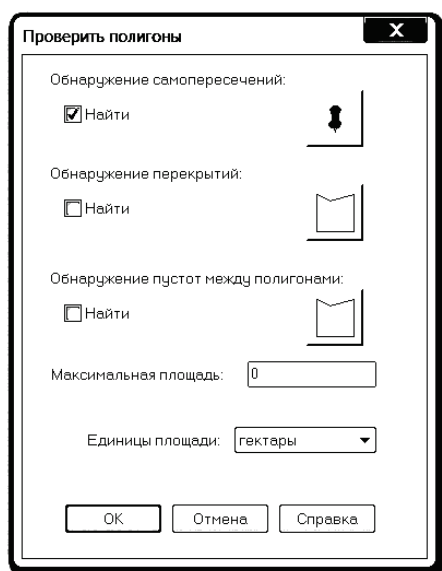
Рис. 4. Выявление самопересечения сглаженного полигона, полученного при помощи модуля MiCAD.
